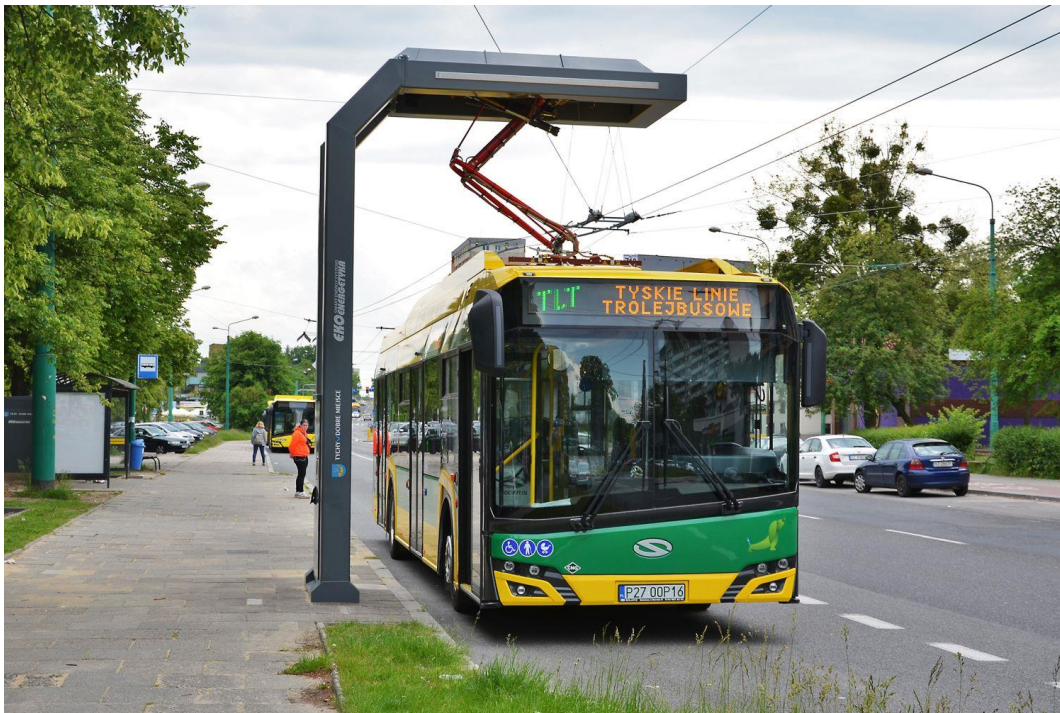
Elektrobus podczas ładowania w zatoce postojowej w ulicy Wyszyńskiego Inwestycja zrealizowana w ramach Projektu „Zakup nowoczesnego taboru autobusowego z napędem ekologicznym na potrzeby rozwoju transportu publicznego w podregionie tyskim”, współfinansowanego ze środków unijnych
