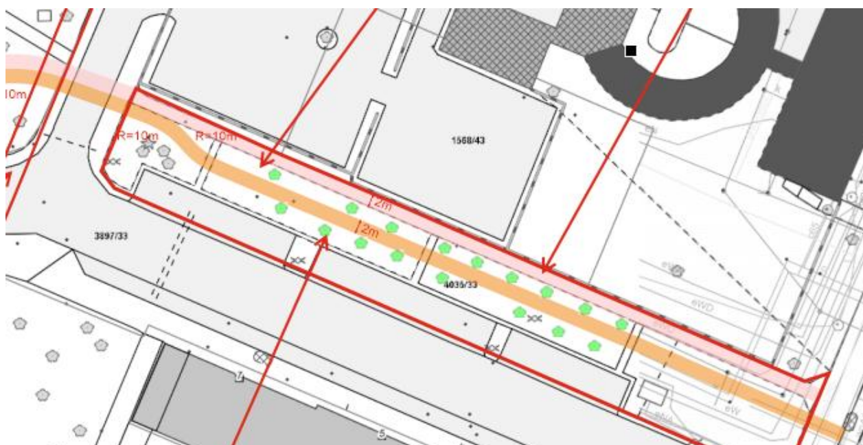
Typowy rzut planowanego ciągu pieszo - rowerowego
